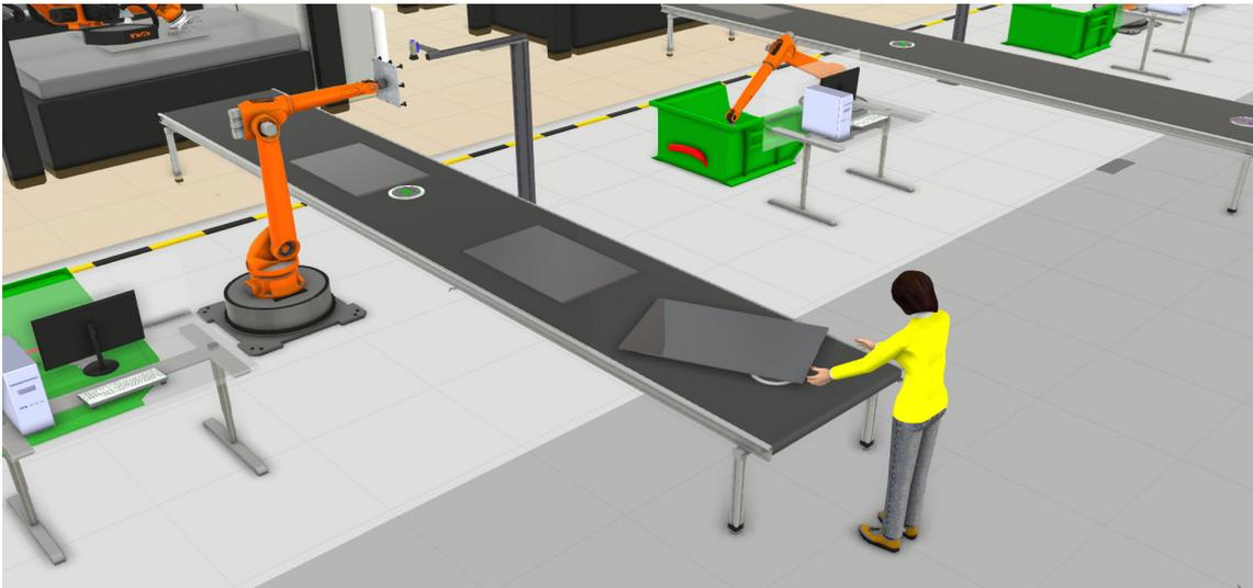
Figura 41. Operario retira el producto de la cinta transportadora para paletizarlo.
