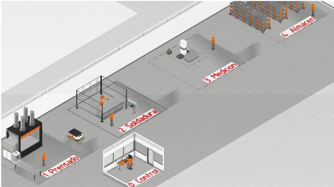
Figura 20. Representación del escenario 1 - Línea de prensado de láminas de acero con control de calidad basado en telemetría y telecontrol.
